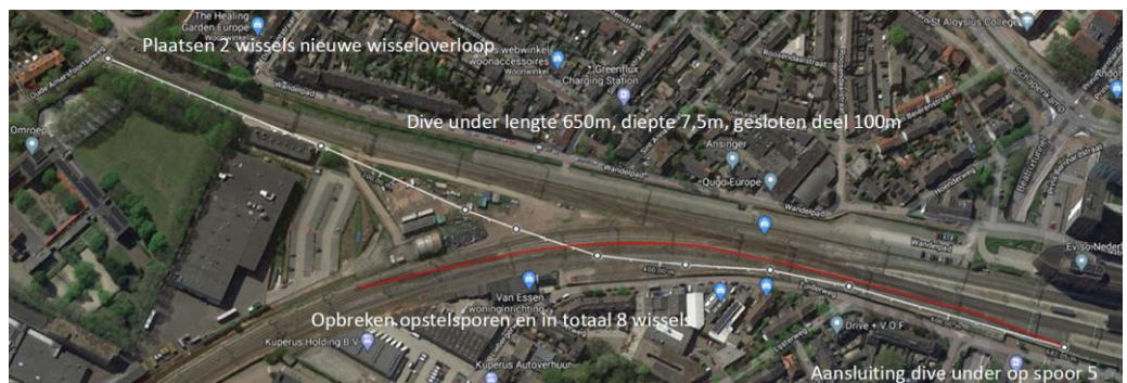
Figuur 5: dive-under bij station Hilversum (rechts)
