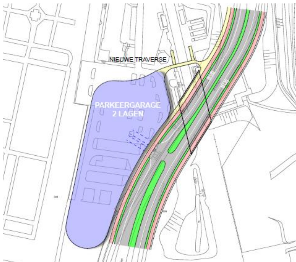
Figuur 9: Nieuw viaduct Bussumergrindweg ter vervanging van het bestaande viaduct om meer ruimte te creëren voor fietsers
