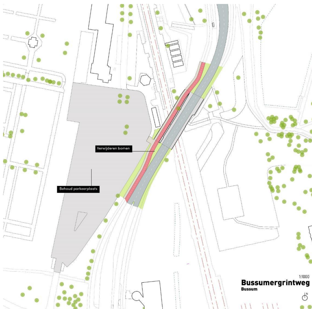
Figuur 10: Nieuwe brede fietsbrug naast het bestaande viaduct Bussumergrindweg
